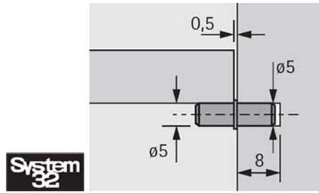
Diamètre de tenon des deux côtés : 5 mm.
